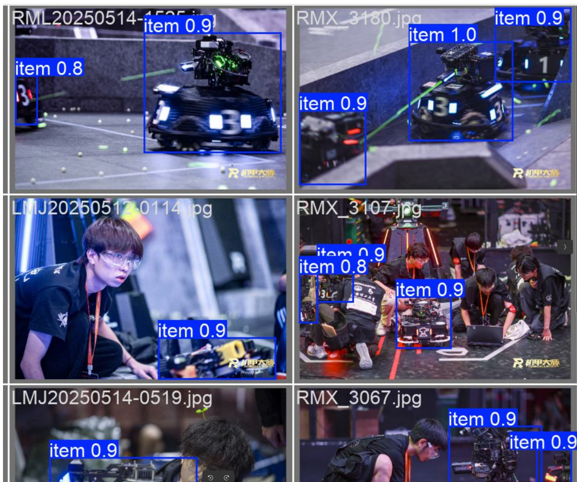
图 2: 我们从官方的图片直播中获取了大量图片带机器人遮挡的原始数据并进行了人工标注。相比于在训练时候引入遮挡 (如随机 mask 掉一部分) 等数据增强, 我们的实验表明这种天然的遮挡训练集能大大增加模型对赛场复杂情况下的适应性。
