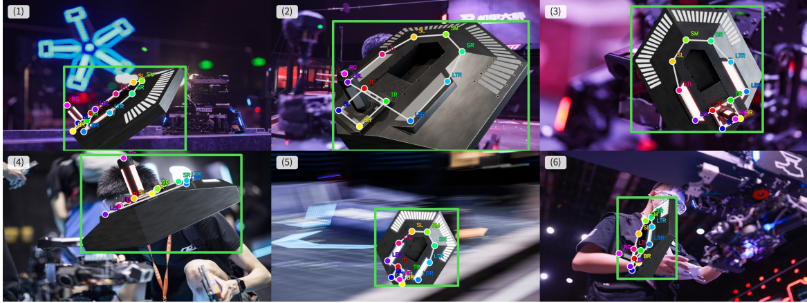
图 4: 合成训练集样本示例。样本由渲染目标素材与真实比赛背景合成得到，用于覆盖不同视角、光照和灯条状态。
