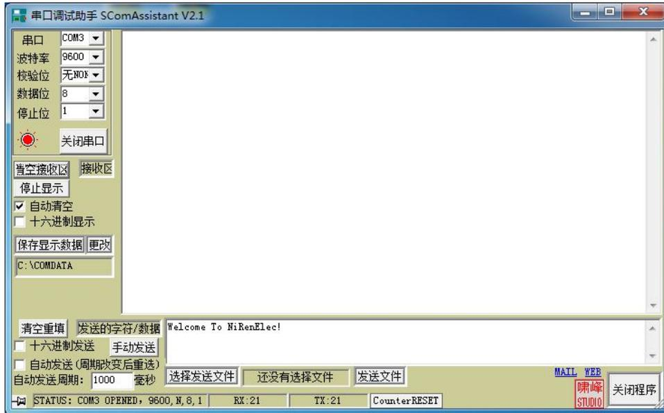
4)、通过串口调试工具发送字符串“Welcome To NiRenElec!”, 单片机串口接收到字符串后, 控制 CAN 模块给 CAN 模块自己发送接收到的串口数据, CAN 模块接收到自己发来的数据后, 再通过串口发到电脑。如下图所示:
