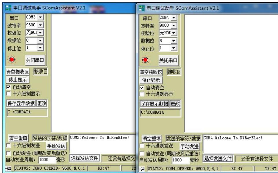
4)、通过两个串口调试工具分别发送字符串“COM3:Welcome To NiRenElec!”和“COM4:Welcome To NiRenElec!”，单片机串口接收到字符串后，通过 CAN 模块给另一个 CAN 模块发送接收到的串口数据，CAN 模块接收到其它 CAN 模块发来的数据后，再通过串口发到电脑。如下图所示：
