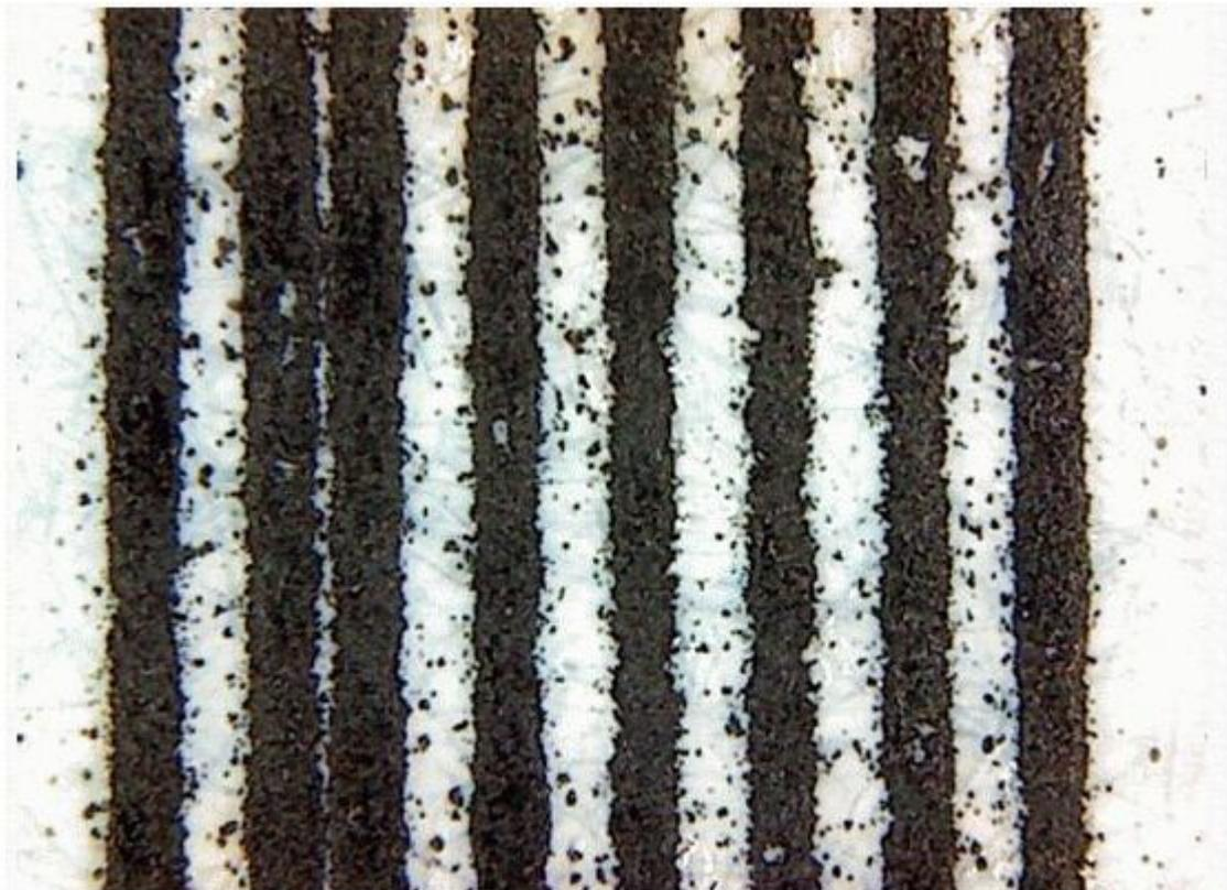
图1：惠普(HP)Laserjet 600 M601(5mil的线宽和间距——显微镜图像)。注意空白处的碳粉斑点和两条并在一起的线。
