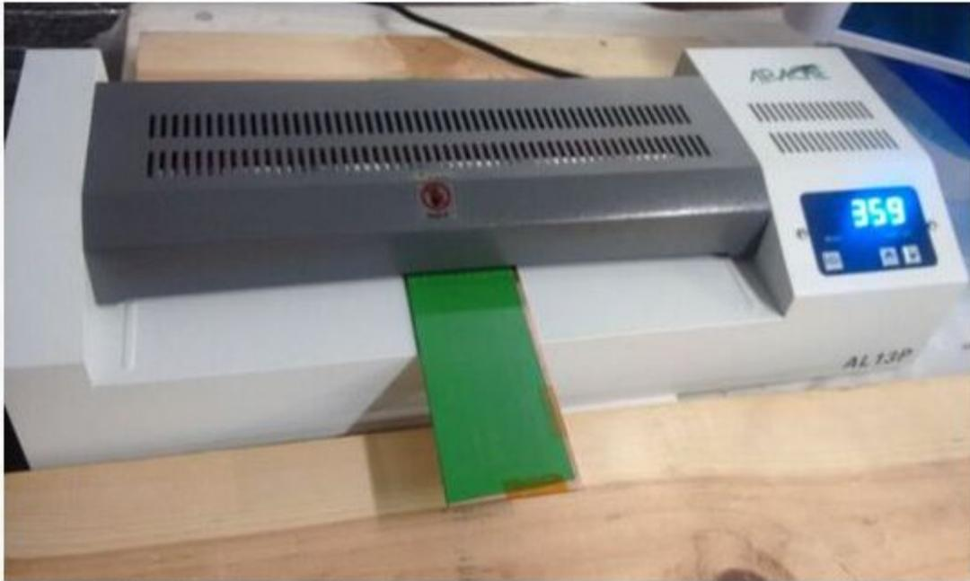
图6：将安装了密封薄膜的电路板再送进层压机8次。
