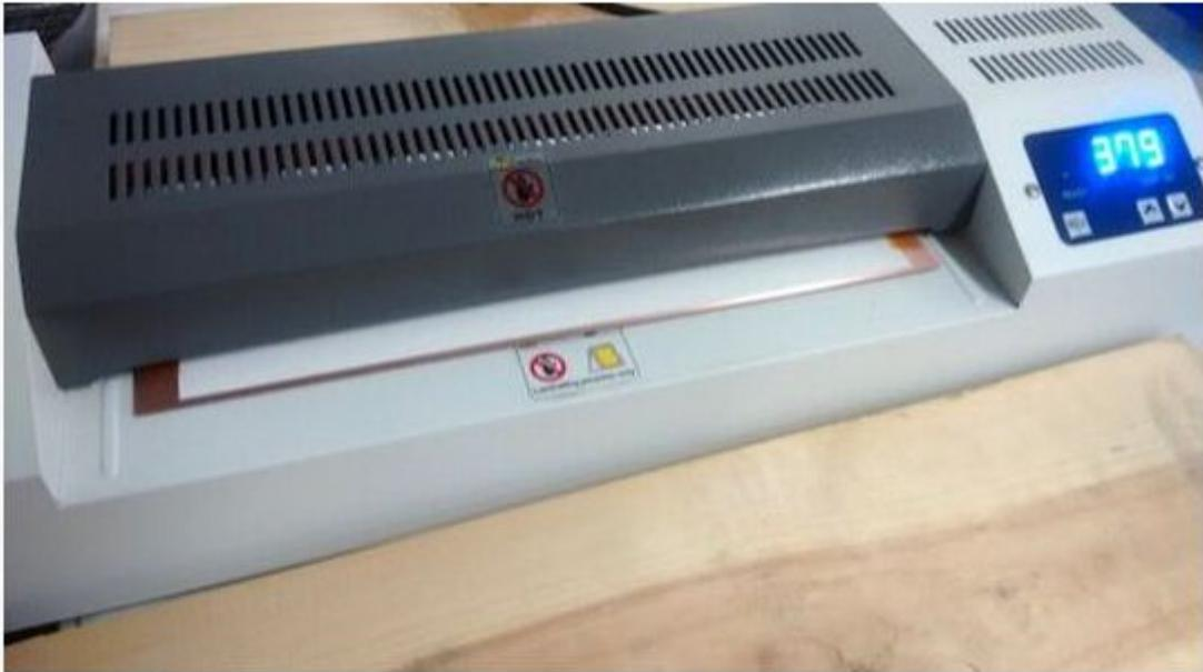
图4：总共送8次电路板进层压机(每个方向两次，先送一面，再送另一面)。
