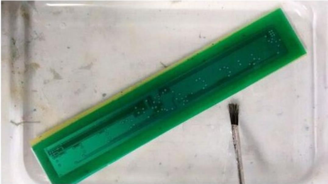
图23：正在显影中的电路板(和聚毛刷)。
