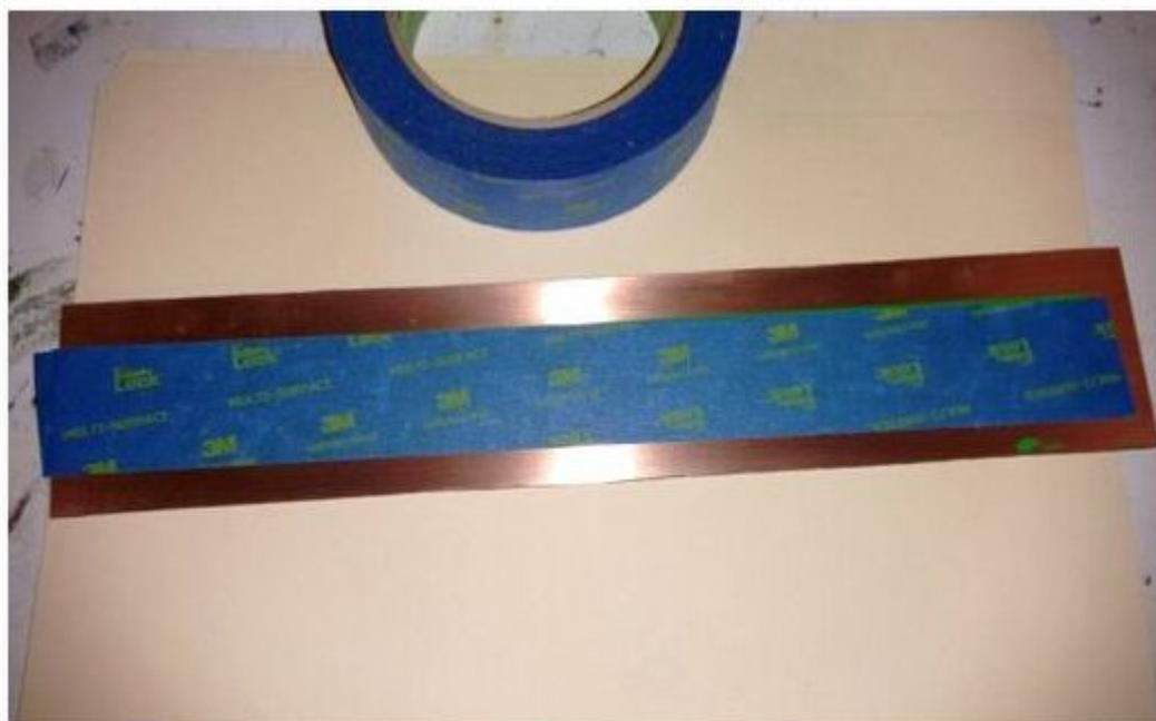
图8：用遮蔽胶带去除多余的密封材料。
