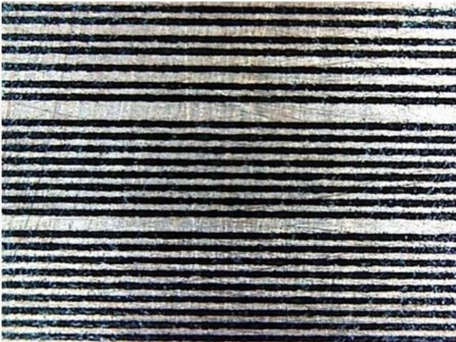
图11：这是碳粉转印后的图像(5mil线—显微镜图像)。
