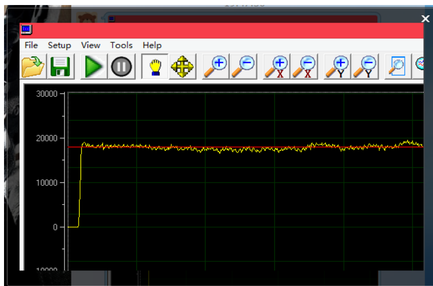
图 4-4 轮子转速控制曲线
