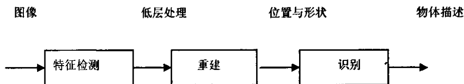
图 1.1 机器人视觉系统基本结构
