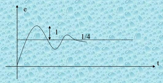
为使PID控制达到最佳控制,必须调整好Kp, Ti, Td等各项系数, 称之为PID参数整定
