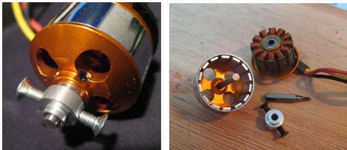
图 1-12 XXD2212 电机结构（摘自网友 liuliu443 所发帖子）
