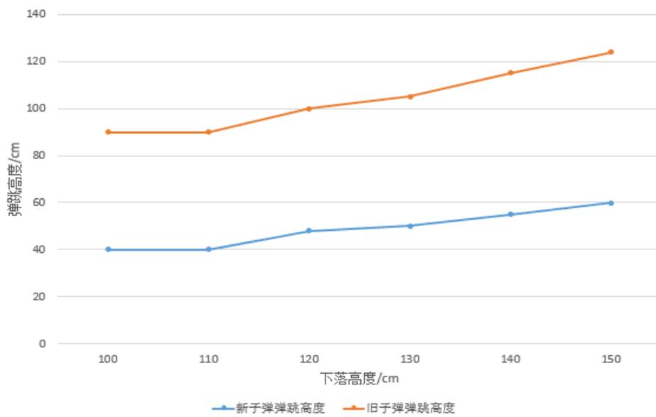
因此可得出结论：相比旧子弹，新子弹的弹跳性能较弱，据分析可能是因为新子弹表层较软，在落地时有了一定的缓冲。
