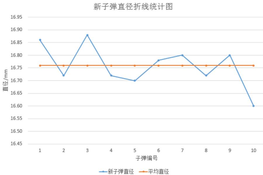
因此可得出结论：新子弹直径小于旧子弹直径，精度处于官方规则中的  $17 \pm 5\%$  之内。
