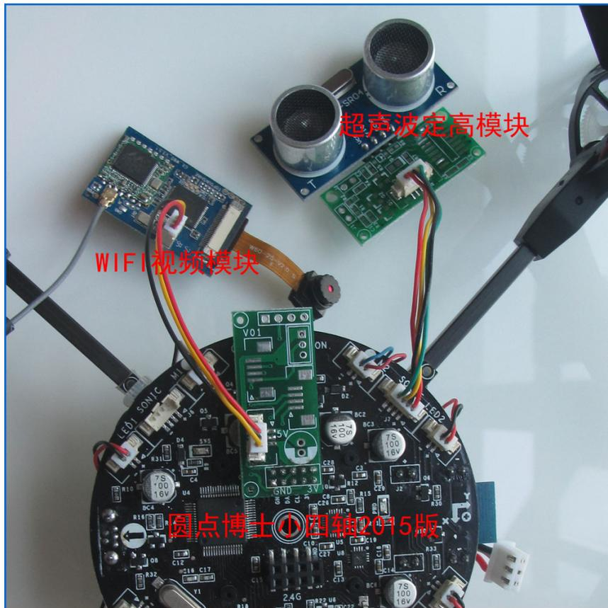
组装后的效果图如下图所示。请注意，由于摄像头和机架是通过软排线连接的，用户必须在下图的基础上**添加一块小木板或者硬纸皮**把摄像头固定到机架上。如果不固定，会造成图像的严重抖动。图中的摄像头模块可以用透明胶带固定到机架上。
