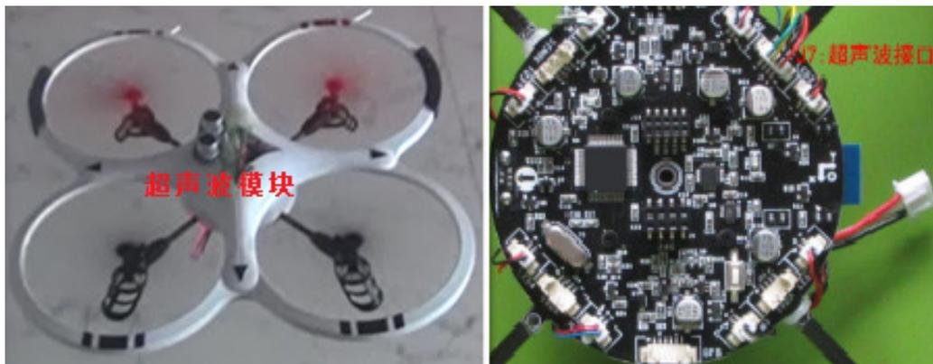
该固件支持普通的超声波模块，比如 SR-04。超声波模块接口 J7 在原理图上的定义如下图所示。定高飞行效果见视频：
