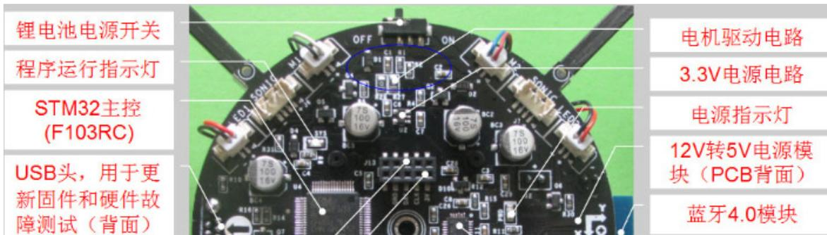
一般情况下，小四轴电源开关可以一直保持在 ON 的问题。当用户不使用小四轴的时候，请断开电池和小四轴的红色连接线。长时间不断开连接的情况，可能会造成锂电池的过放电，从而损坏电池。
