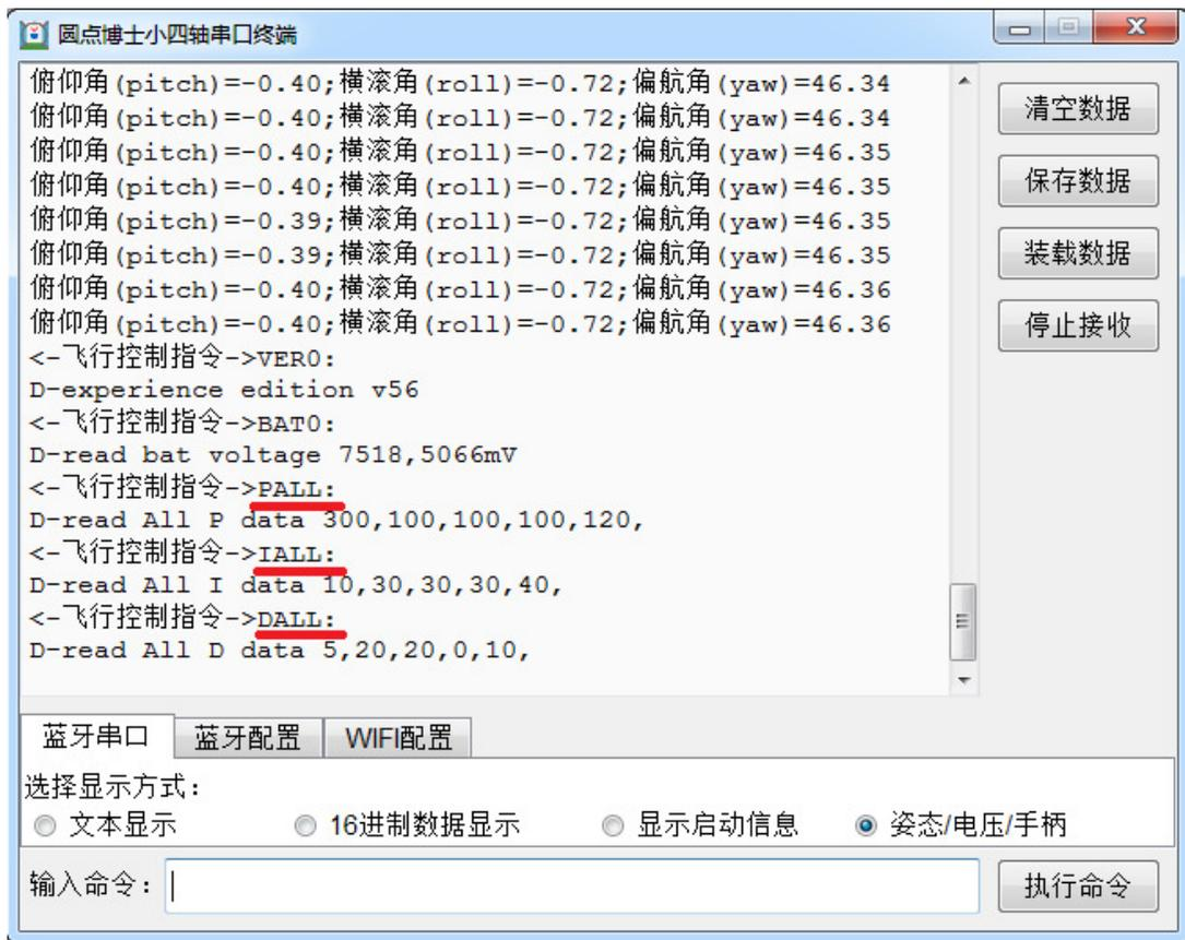
通过 **WROP**, **WROI**, **WROD** 指令可以修改小四轴的外环 PID 参数。指令后面必须带 4 位的十进制数，如 0001, 0010, 0020 等等。通过 **WRPX**, **WRPY**, **WRPZ** 指令可以修改小四轴的内环 P 参数，通过 **WRIX**, **WRIY**, **WRIZ** 指令可以修改小四轴的内环 I 参数指，通过 **WRDX**, **WRDY**, **WRDZ** 指令可以修改小四轴的内环 D 参数指，指令后面必须带 4 位的十进制数，如 0001, 0010, 0020 等等。
