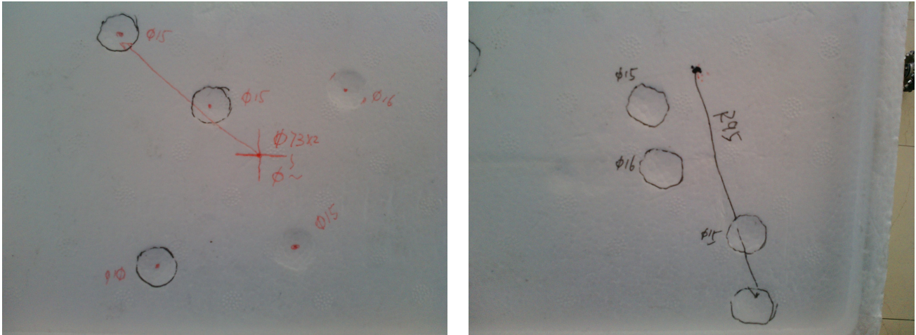
图四、新旧子弹分散半径和弹痕直径 (R 新=73mm、R 旧=95mm、D 新=D 旧≈15mm)
