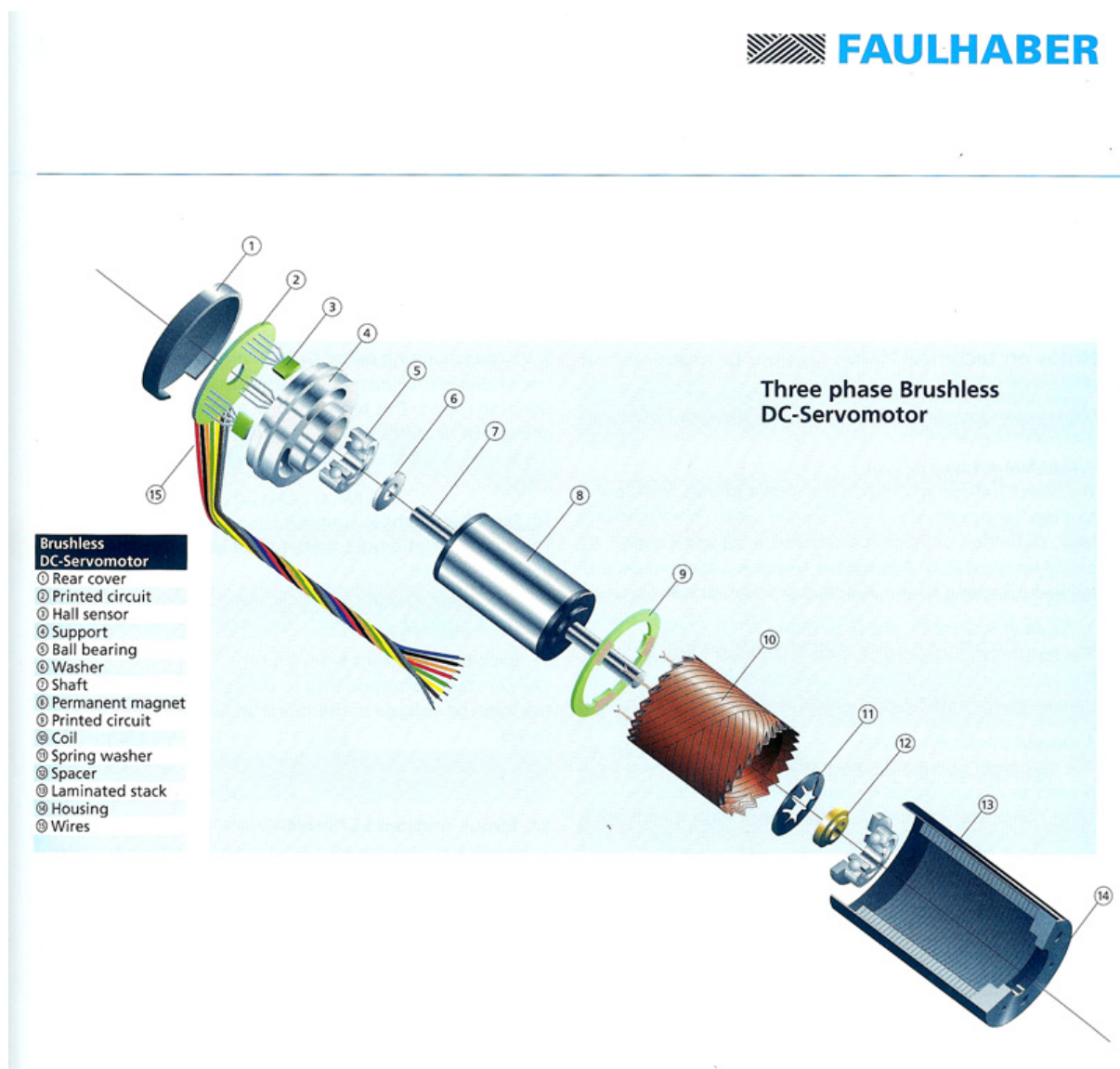
图 49 Faulhaber 无刷电机结构（摘自 Faulhaber 电机手册）
