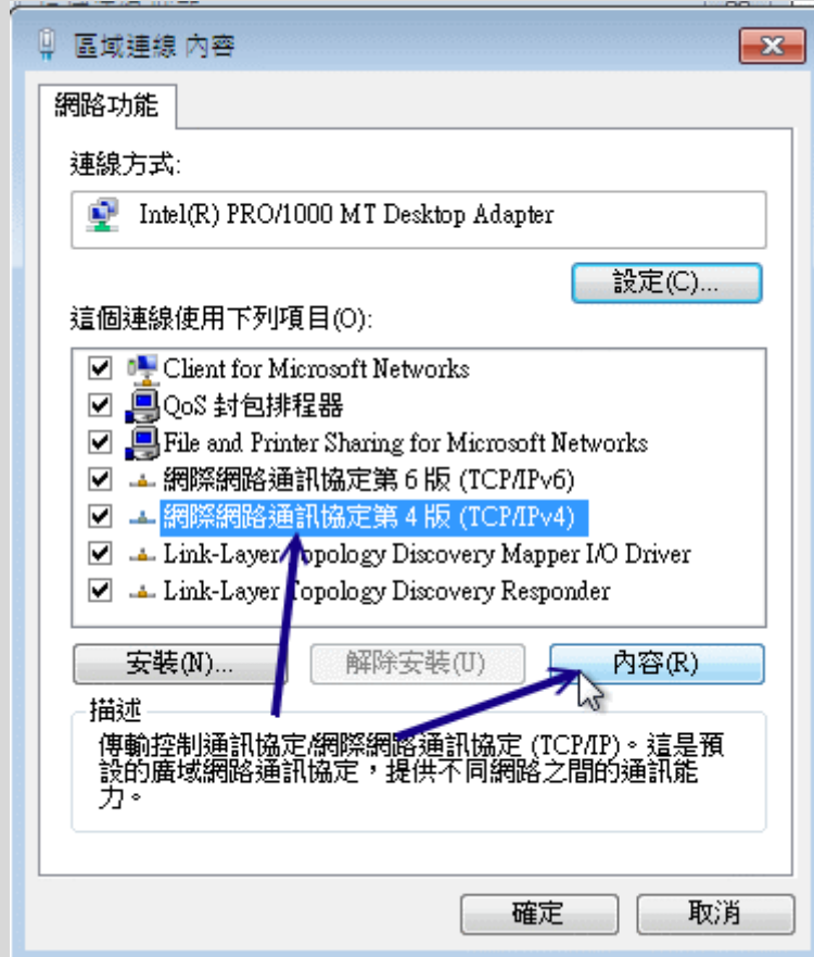
图 12.3-2、局域网的 Windows 7 系统设定 DHCP 的方式
