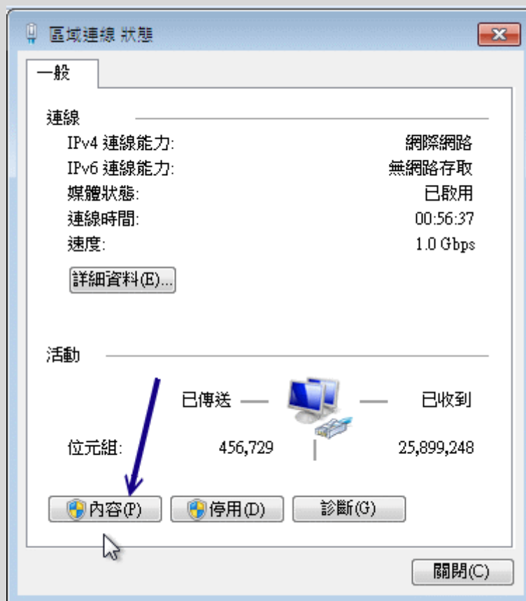
图 12.3-1、局域网的 Windows 7 系统设定 DHCP 的方式
