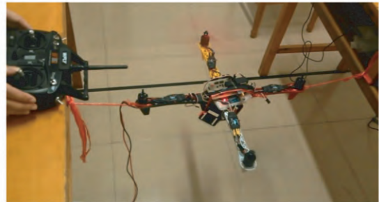
图6 姿态PID控制测试
