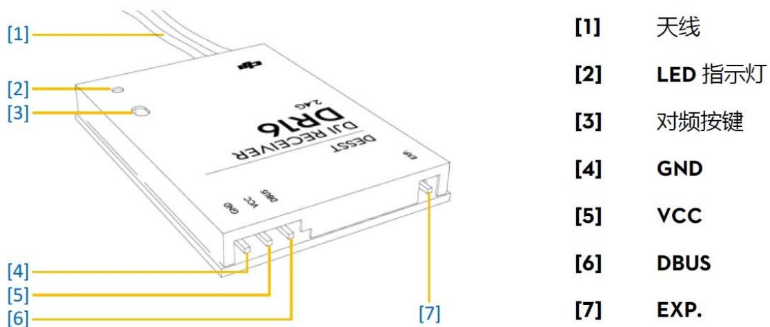
这里重点关注 4/5/6 三根控制线，4 是地线，5 是 VCC 用于为接收机供电，电压范围为 4-8.4V，6 是 DBUS 数据输出线
