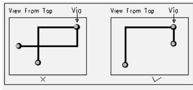
防止信号线在不同层间形成自环。在多层板设计中容易发生此类问题，自环将引起辐射干扰。
