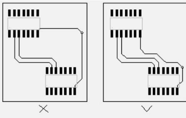
环路最小规则，即信号线与其回路构成的环面积要尽可能小，环面积越小，对外的辐射越少，接收外界的干扰也越小。针对这一规则，在地平面分割时，要考虑到地平面与重要信号走线的分布，防止由于地平面开槽等带来的问题；在双层板设计中，在为电源留下足够空间的情况下，应该将留下的部分用参考地填充，且增加一些必要的孔，将双面地信号有效连接起来，对一些关键信号尽量采用地线隔离，对一些频率较高的设计，需特别考虑其地平面信号回路问题，建议采用多层板为宜。
