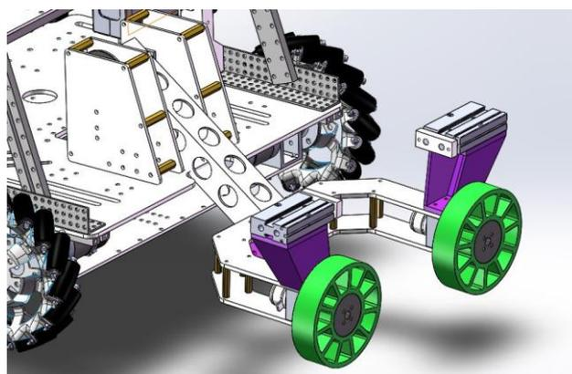
同时该机构也可实现积木的放置与城堡的积累，可直接通过硅胶轮的形变将积木块从城堡中拆出或将积木块按入城堡。另外为防止从仓库取出积木块时积木块的连接，在摩擦轮的上方设计有 2 个缸径 10、行程 25 的微型气缸，在摩擦轮将累在一起的上层积木取出时，气缸将下层积木加紧固定，从而使摩擦轮可通过摩擦力将压下一层的积木分开。
