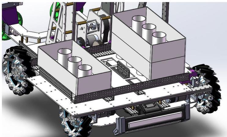
同时该储存机构还可直接将储存的积木翻出，快速实现将收集到的对方积木运回资源区的目的。该部分机构通过一个通过雕刻机切割出的 pom 板 4 模齿轮实现翻板的转动，RM2006 的最大持续扭矩为 1N.m，该机构的减速比为 5: 9，由此可由计算得知将大量积木翻开的难度并不大，从而验证机构的可行性。
