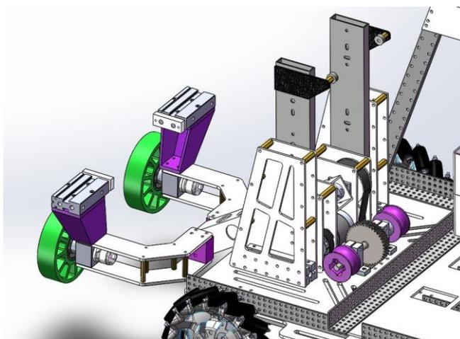
线轴部分的动力我们使用了  $45^\circ$  的斜齿轮进行传动，这样设计可将电机的位置移到底板下方，从而将底板上方的空间节约了出来，为气动部分的控制元件及抬升机构的线路留出空间。斜齿轮产生的轴向力我们通过两侧的光轴支架进行支撑，使结构保持稳定。
