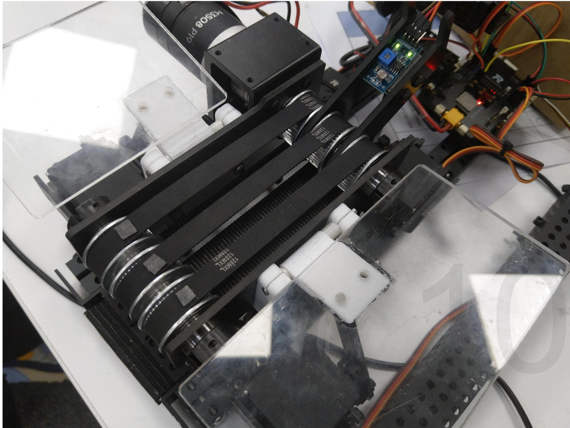
2：使用了3条同步带作为方块的传送带，充分利用了官方剩余的同步带，光轴等物资。一方面，三条同步带中间留有足够空隙供之后的方块翻转机构使用；另一方面，三条同步带加上足够间隙后总宽在60MM以内，而方块边长50MM，刚好顺着传送到移动不会被两边的亚克力板所挤压。同时，方块放在三条同步带上，同步带几乎没有下陷。
