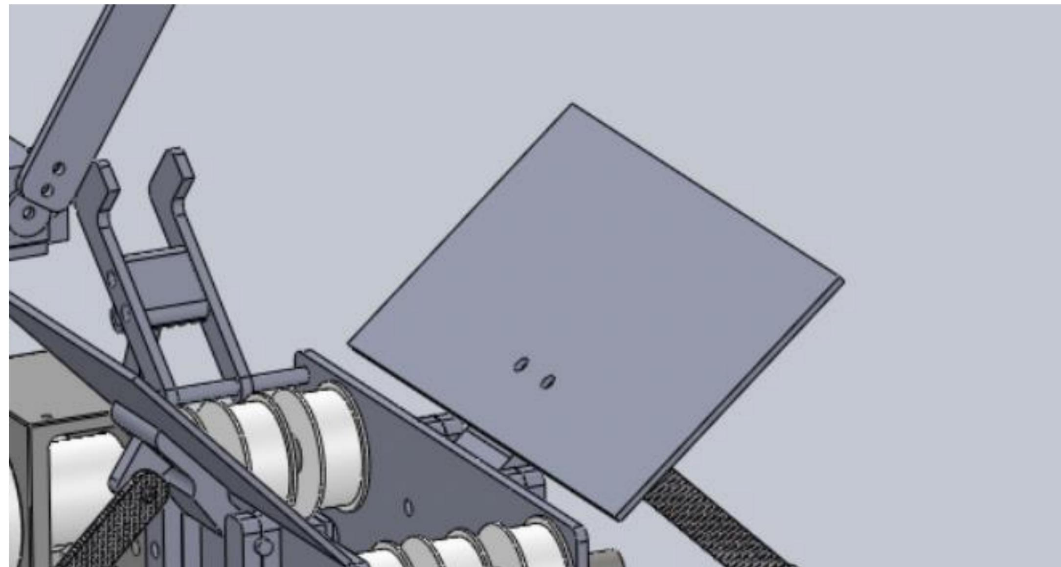
解密结构使用了2块较大的亚克力板作为侧板，方块可以随意的丢在板上，之后通过舵机控制其合起，可将方块稳定的置于传送带上。这个人性化的设计，提高了操作手的容错率，也省去了对不齐造成的烦恼。同时，亚克力侧板不会遮挡环境光，解密摄像头无需再增加补光灯
