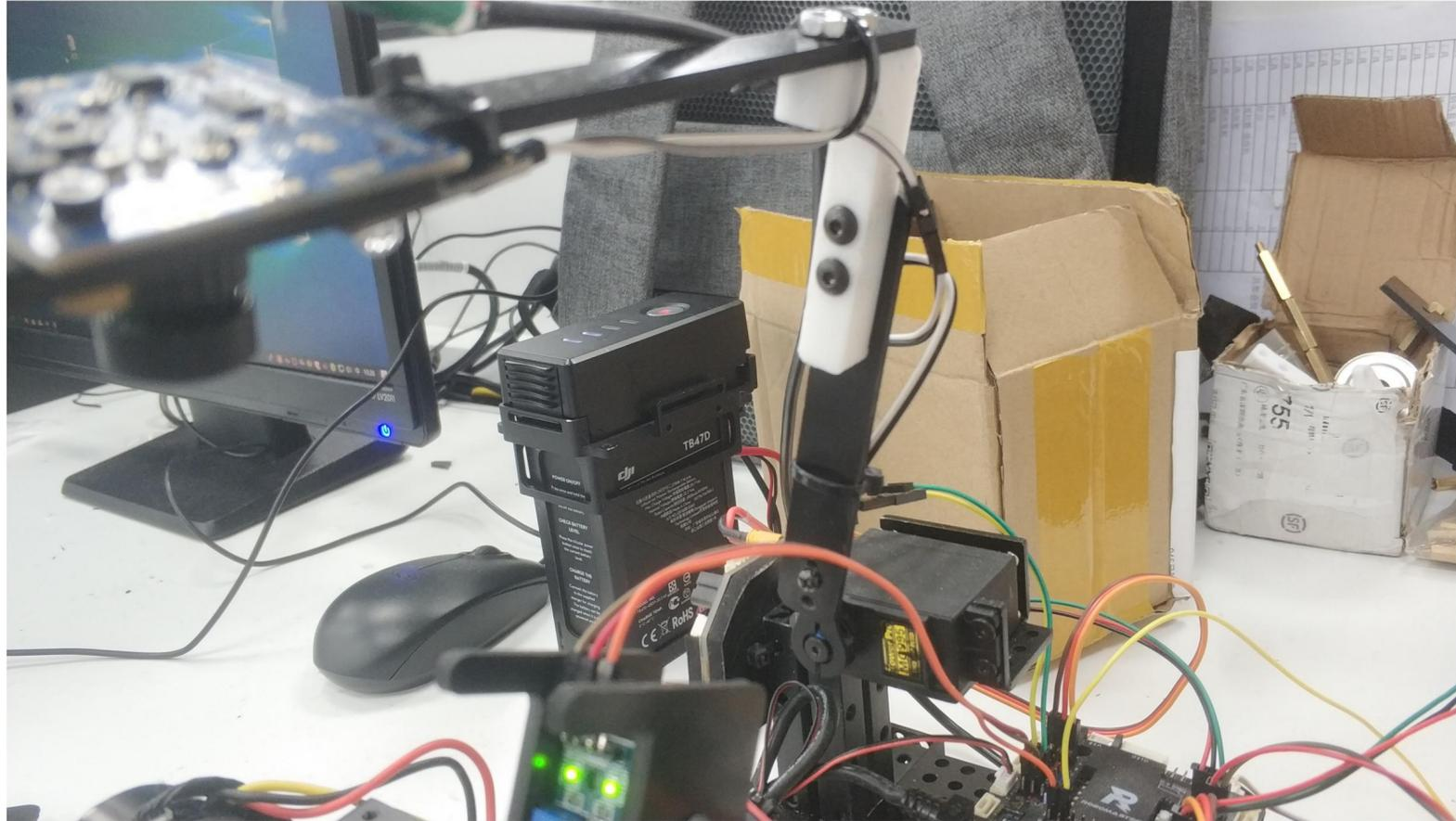
4：翻转机构的翻转臂直接以光轴作为其旋转轴，保证可以达到与轨道相切的位置，方块可以比较平滑的滑上翻转臂进行翻面的操作。为了保证每一次做出的翻转动作均为有效动作，我们在翻转臂上添加了一个光电传感器，当方块滑上旋转臂达一定高度后，再进行翻转，即可恰好翻转一个面。
