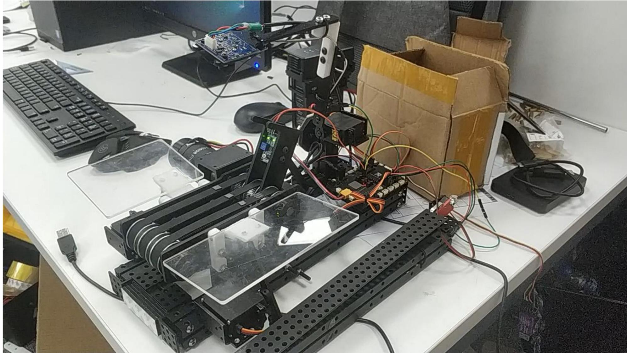
7：使用微动开关及杠杆设计了一个奇妙的触发机关，操作手在放置方块后，只需用机械臂轻轻一拍，即可启动整套解密机构。
