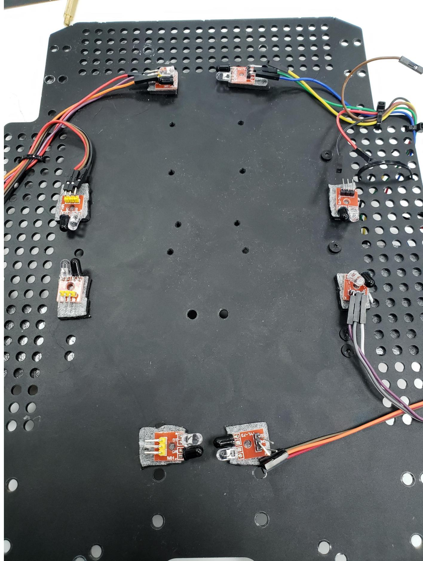
一开始，我们使用的是四路双红外传感巡线。这种思路的好处是可以完全不管地上的ID卡的颜色，只需要在经过ID卡时将运行方向后侧的双传感器暂时停止功能，就可以保持巡线的稳定性。唯一的问题是当机器偏移过大（比如被撞飞了），光靠底盘现有传感器难以矫正回来，因此我还引入了陀螺仪进行辅助矫正。但因为我们在更换底盘时的操作失误，造成了传感器损坏的情况。由于找不到足够的替换用的传感器，我们只得更换了巡线的设计思路。
