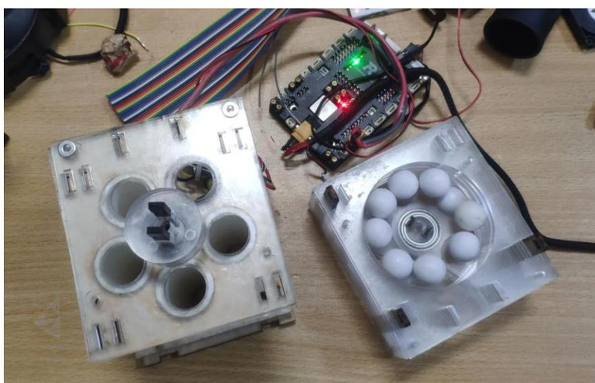
图 27.第四代拨弹轮实物，左边是预排弹结构，右边是弹丸排列满的预旋转层
