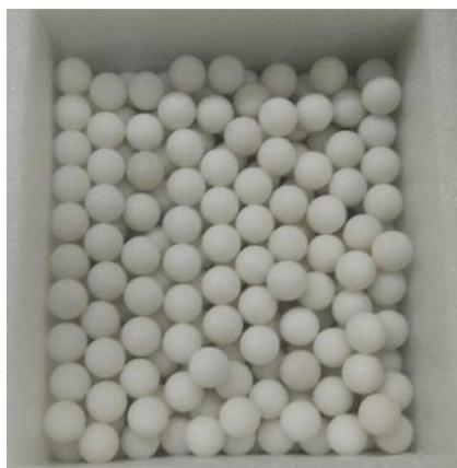
图 1.十七毫米弹丸的等径密堆积
