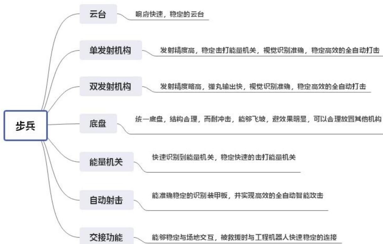
机动性高，灵活性高，云台自由度高。步兵机器人作为比赛中的基础兵种，基本的机动性需要有充分保证，同时也需要有云台，具备发射 17mm 小弹丸的攻击能力，以及远距离激活能量机关的能力。
