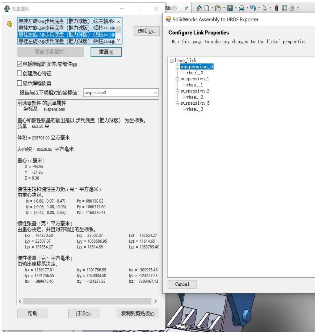
图4-8 使用 Solidworks 获取各刚体的惯性张量
