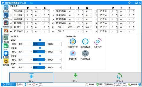
4、参数设置完成后可按照速度帧格式使用基本收发设置电机转速,通过数据波形观察 参数效果。
