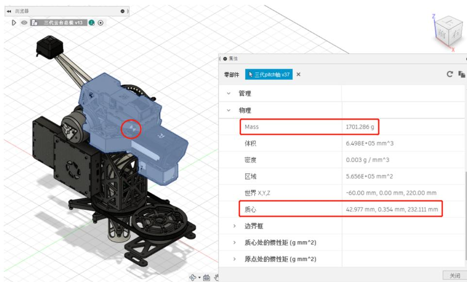
图 1: 英雄机器人云台的 pitch\_link 参数测量, 红框中为测量结果
