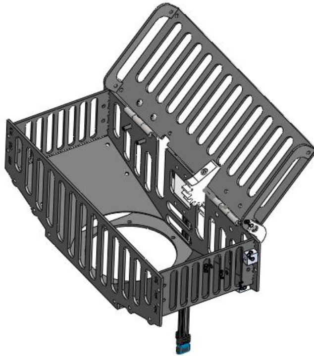
图 2-12 齿轮传动开合弹仓盖
