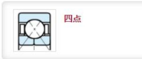
四点接触轴承当只有纯轴向载荷作用时，钢球和套圈就成了两点接触；
