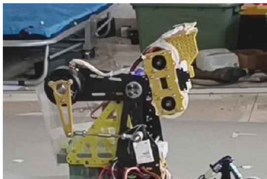
图-2 四连杆驱动 pitch 轴转动方案
