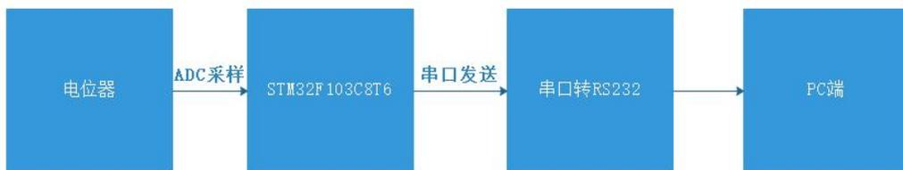
图 3-8 自定义控制器数据传输流程图
