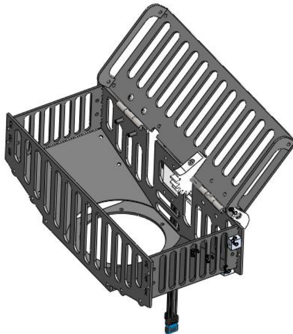
图 3-21 齿轮传动开合弹仓盖
