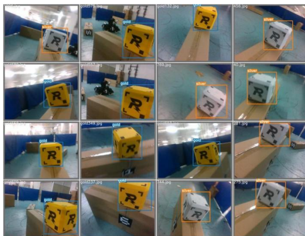
图 3-33 图像识别算法 yolov5 对于金银矿石的识别训练
