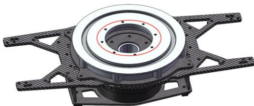
<图 2.21：云台连接螺纹孔>
