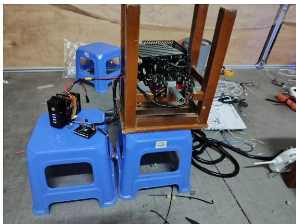
<图 8.2：无枪管发弹测试平台>
