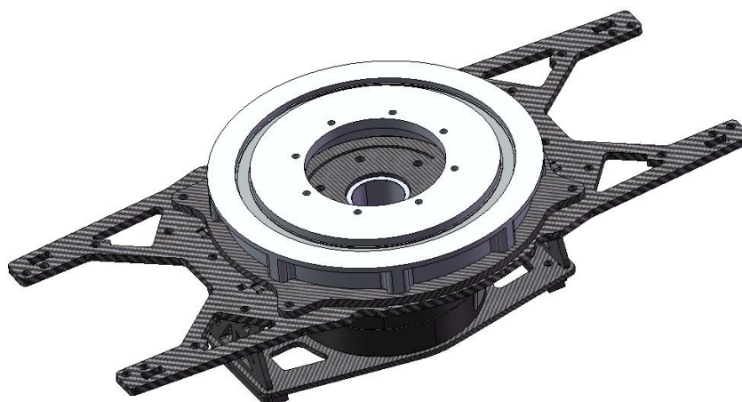
〈图 2.16: yaw 轴模块装配图〉
