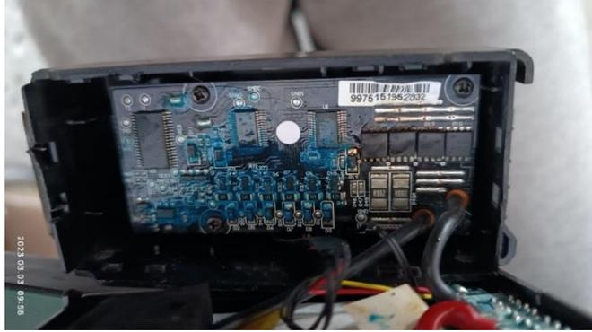
此时可以对保护板进行一些维修操作了，如按键、LED 等易损件的更换，但由于保护板**仍然带电**，操作时请务必小心，也可以拆下保护板再进行操作。保护板工作用电从平衡排线取电，先取下平衡排线或功率线均可，不影响拆解和后续使用。正常情况下，重新插上平衡排线后保护板会先亮起两颗 LED，然后显示当前电量，此时电池处于开机状态，建议确认状况正常后关机以保证后续操作的安全。平衡排线中两根彩色线为通讯线，其余为电芯电压监测线，可以通过其测量电芯电压。
