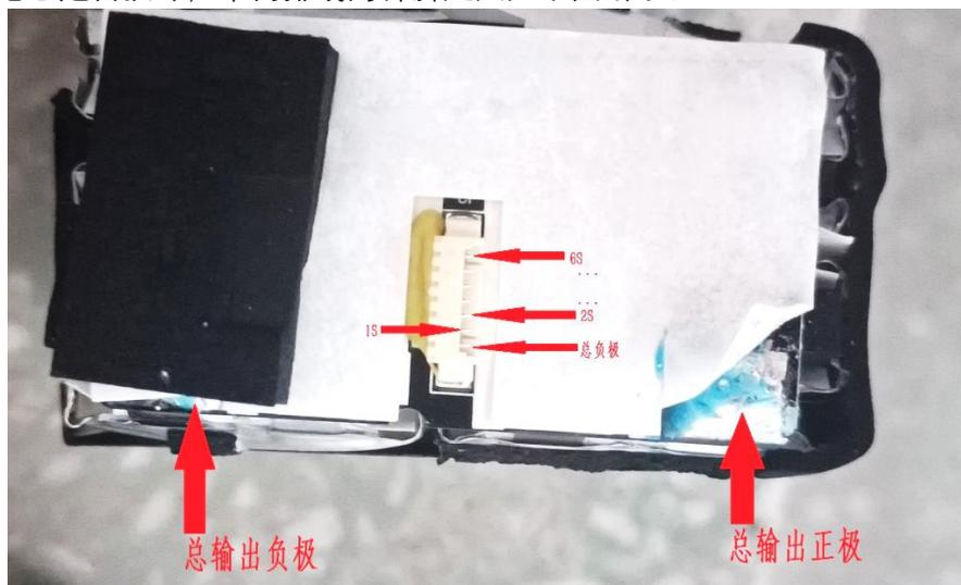
使用万用表可以测量每个电芯的电压，测量时请注意避免造成短路。如果测量到有电芯的电压明显偏低，如单芯低于 3V，即表明电芯已经损坏。对于此类电池，为了确保安全，请勿继续使用，并按照当地法律法规将其妥善丢弃于废电池回收箱或交给有资质的回收机构。**不要尝试单独更换损坏的电芯**，电池组的电芯在组装前均进行过一致性检查与配对，更换单个电芯会导致电池组性能下降、功能异常，并可能引发危险。如测得各电芯电压均衡且正常，则说明电池保护板可能存在故障，可以尝试更换保护板解决。
