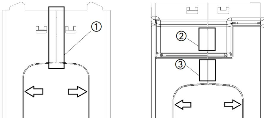
上面两张图标明了外框卡扣所在的位置（外框底部也有卡扣，但实际上拆开图中卡扣即可完成维修，不需要拆开底部卡扣）。对于②处，如拆解较为困难，可以按照下图的方法，将一薄片状物体穿过图中所示缝隙再取出，使卡扣松动，然后拆开此卡扣（注意，不要插入到金属触点的位置！）对于①③两处，请按照上图中箭头所示方向对外框施力。注意，不要对外框以外的位置施力。外框以外的位置非常脆弱，对其施力可能导致电芯破裂或刺穿，进而引发火灾或爆炸等危险。拆开外框后即可取出电池本体，取出时请务必小心操作。TB47/TB48/TB47D/TB48D/TB47S/TB48S 的外壳结构相同，可以互换安装。
