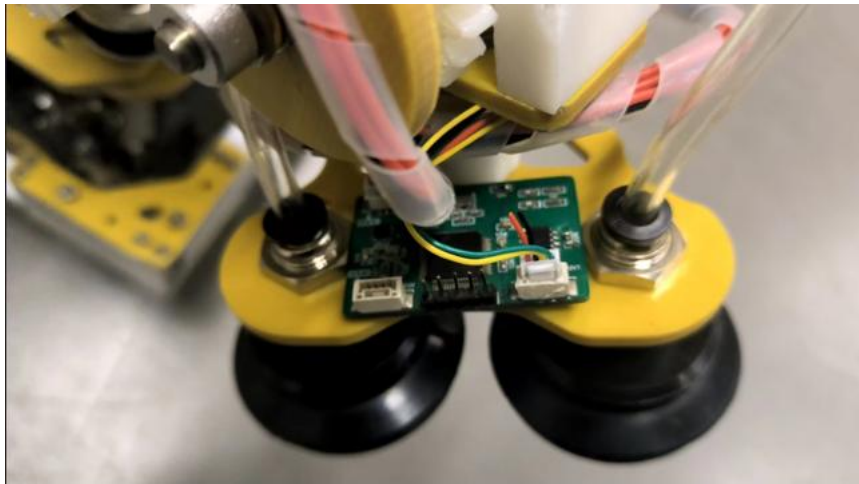
图 2.3-3 控制差动关节的陀螺仪
